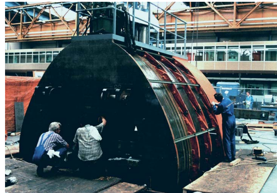
Wire-wound press frame. Press force 200,000 kN
