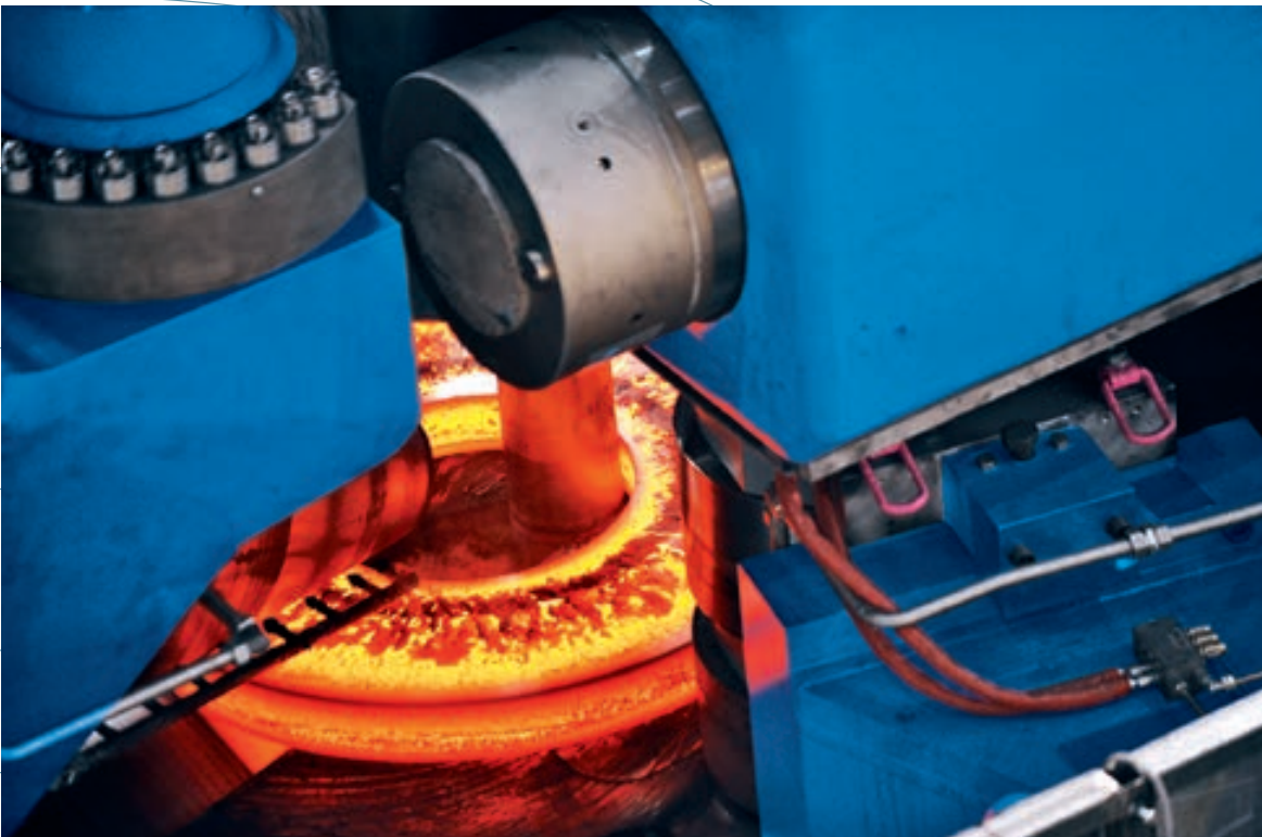
Dornwalze innerhalb des Ringrohrlings, Axialwalzen (links) und Zentrierwalze (unten rechts)
