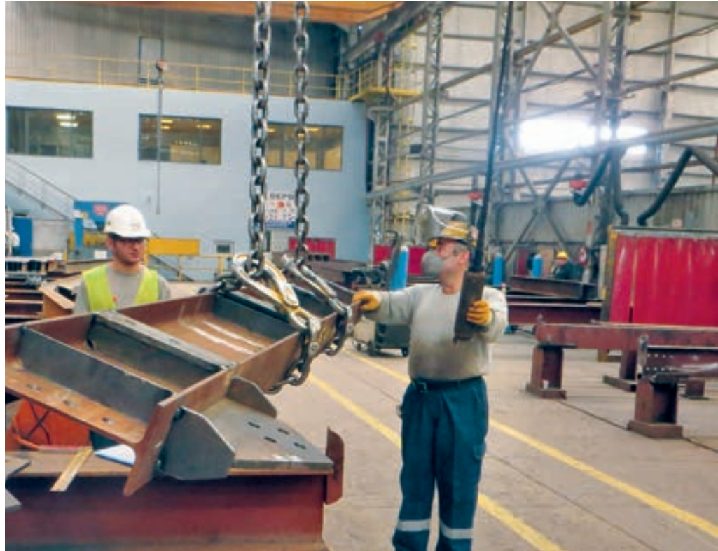
Bauteiltransport zum Schweißplatz nach erfolgreicher Geometriekontrolle
