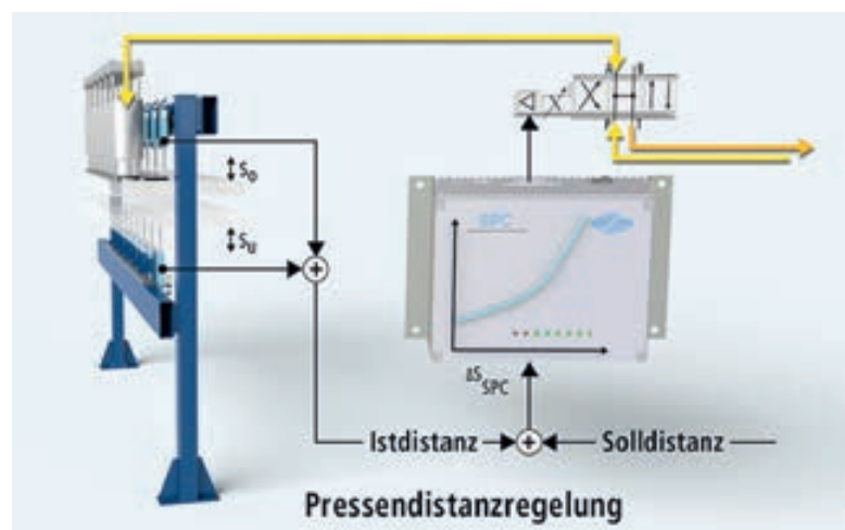
Messsystem zur Bestimmung des Pressspaltes
