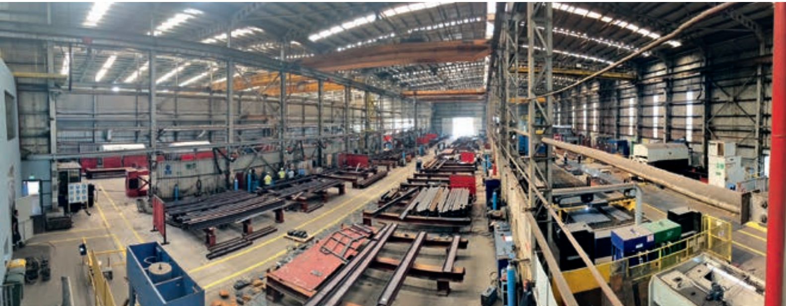
Atilla-Workshop 1 in Kocaeli, links/Mitte: Assemblierung und Schweißen; rechts: Zuschnitt-, Bohr- und Umformstationen
