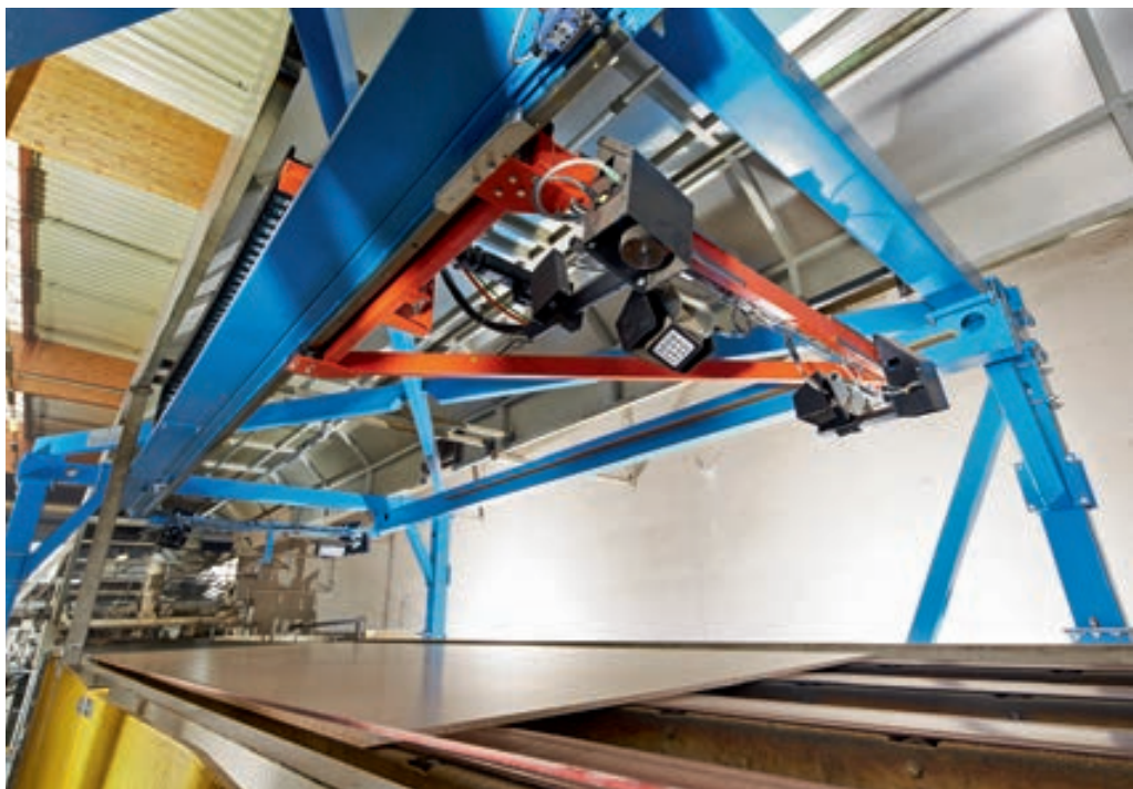
Messsystem zur geometrischen Vermessung der Platte – online!
