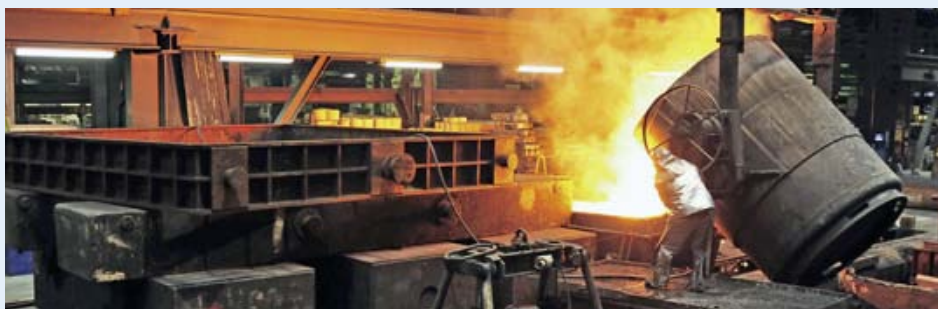
Der große Augenblick: Das Flüssigeisen des künftigen Motorblocks fließt in die Form
