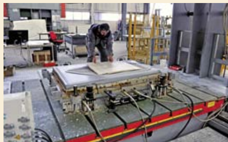
Einlegen der Faserverbundmatte – Probelauf
