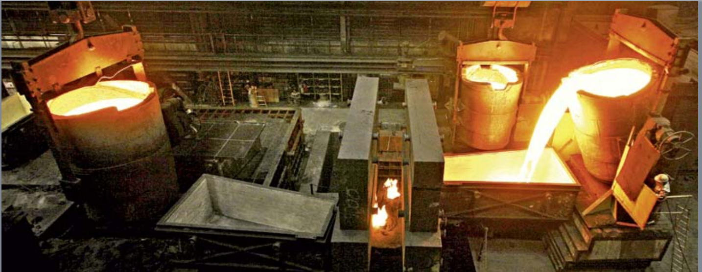
Abguss eines TUK-141-Behälters
