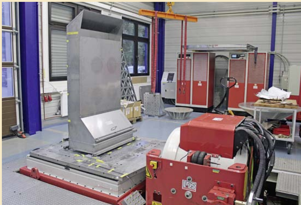
Erdbebensimulation im NIS-Technikum: Aufgespannt auf einem Rütteltisch erfolgt die Zuverlässigkeitsüberprüfung der H2-Rekombinatoren
