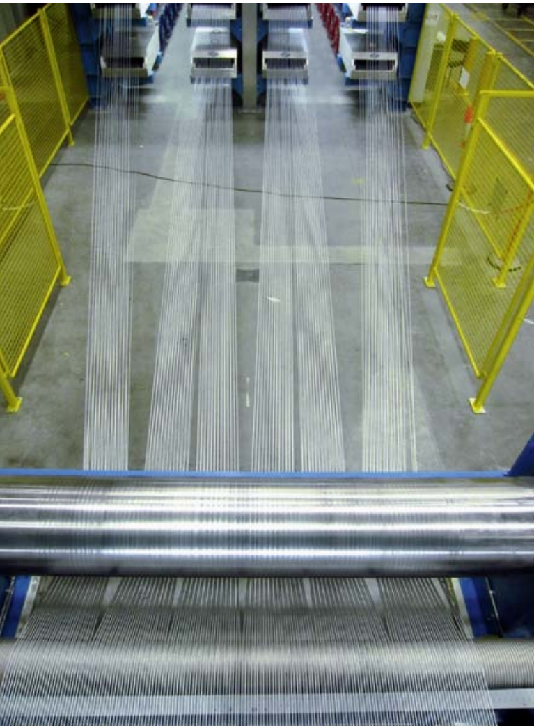
100%ige Kontrolle über die tatsächliche Seilspannungsverteilung
