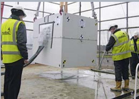
Vorbereitungen für den Falltest
