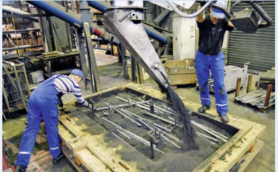
Einfüllen des Quarzsands in den Kernkasten
