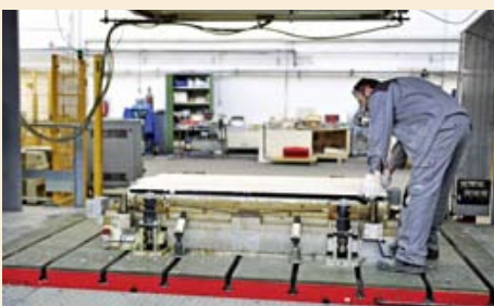
Entnahme des fertigen Teils – Probelauf
