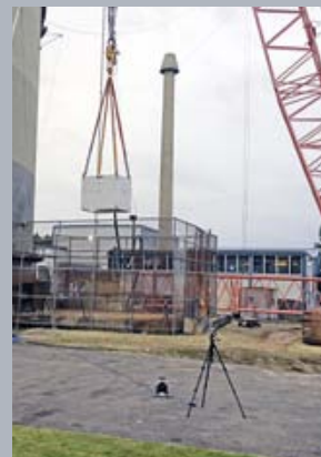
Falltest: Abwurf aus 5,20 m Höhe
