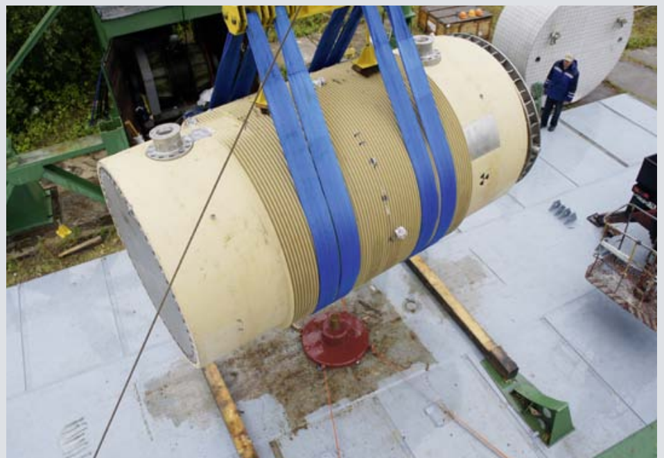
Unfallszenario: Aufprall auf einen Stahldorn mit 15 cm Durchmesser aus 1 m Höhe zur anschließenden Dichtheitsüberprüfung
