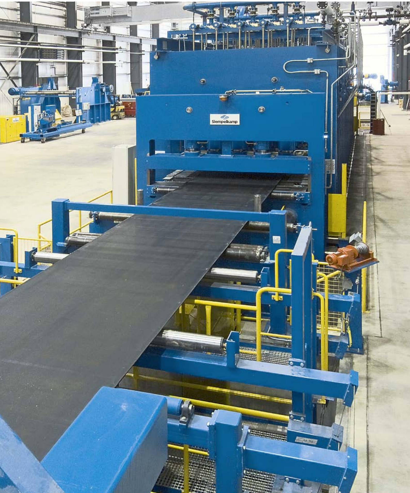
Viel-Kolben-Pressen zur Vulkanisierung der Förderbänder
