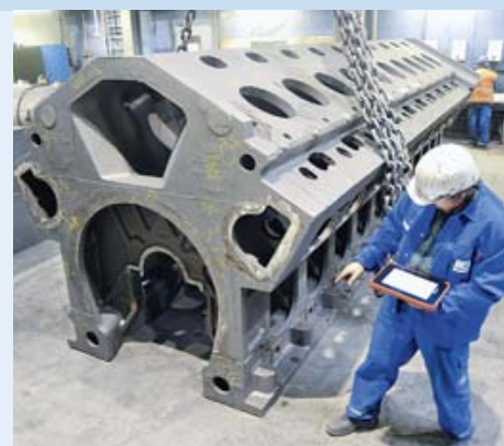
Kontrolle der bereits getätigten Arbeitsschritte in der Putzerei
