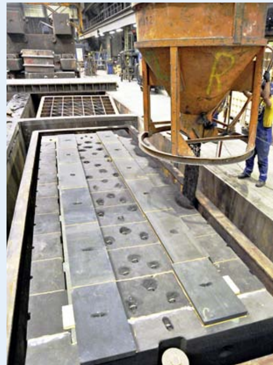
Motorblock „in den Sand gesetzt“: Verfüllung von Rahmen und Oberkasten mit Quarzsand
