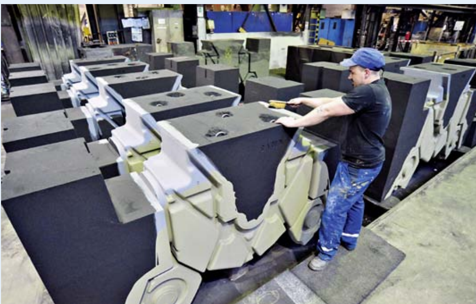
Des Motors Kern: fertig beschichtete Kerne
