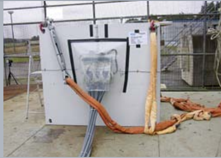
Anbringung von Dehnungsmessstreifen und Beschleunigungssensoren vor dem Falltest zur Datenerfassung und anschließenden Auswertung
