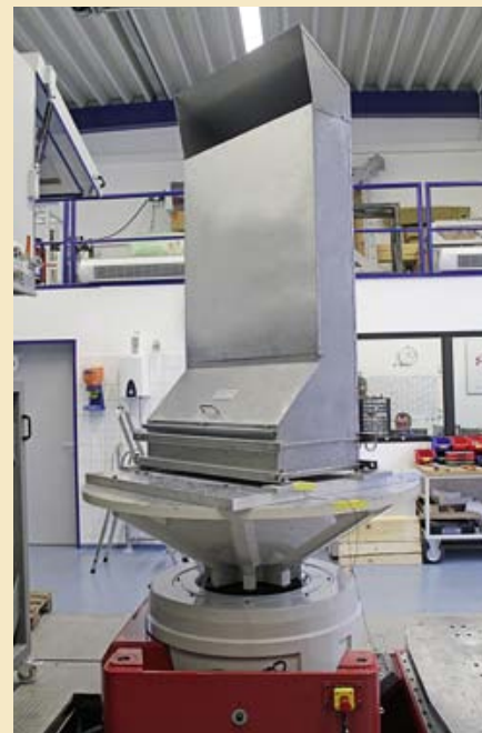
Erdbebensimulation im NIS-Technikum: Aufgespannt auf einem Rütteltisch erfolgt die Zuverlässigkeitsüberprüfung der H2-Rekombinatoren
