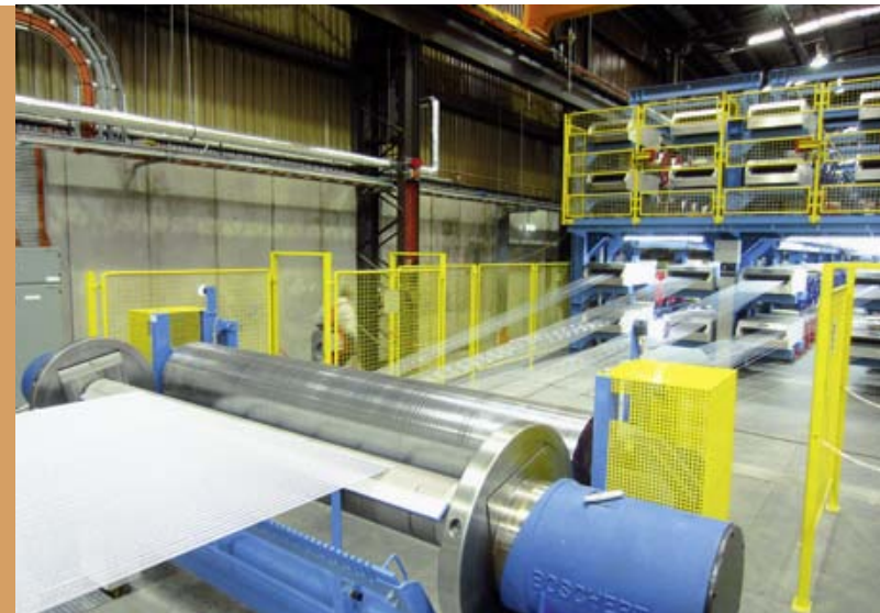
Neues Rollenkamm-Konzept mit Seilscheibenrolle
