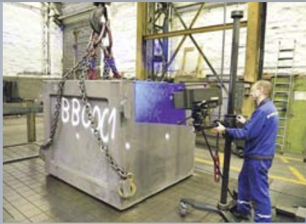
Optische 3D-Vermessung des neuen Behältertyps
