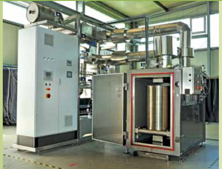
Zwei-Fass-Trocknungsanlage für das Kernkraftwerk Qinshan, Phase II
