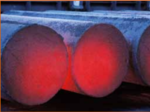
Glühende Graphitelektroden nach der Graphitierung (Foto: 2010 ©SGL Group)
