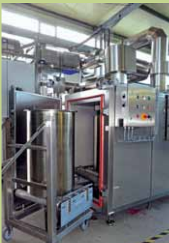
Handwagen und Fass-Beförderungssystem in der Trocknungskammer
