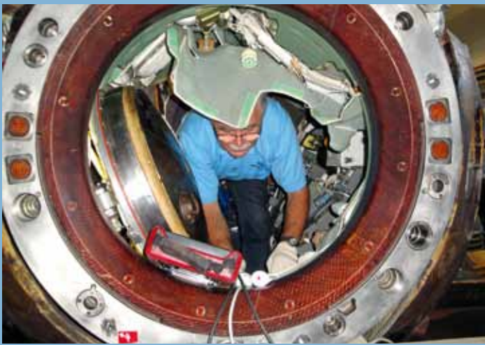
Oben: Dr. Peter Seliger während der visuellen Inspektion im Inneren der Landekapsel Unten: Prüfungen in engsten Raumverhältnissen
