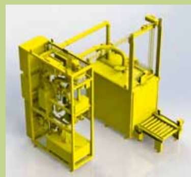
3-D-Modell des C2 Facility Package (Abfallbehandlungsanlage) für das KKW Hainan: links – Trockner-, Sortier- und Verdichtungsanlage, rechts – Fasrocktrockner
