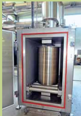
Handwagen und Fass-Beförderungssystem in der Trocknungskammer
