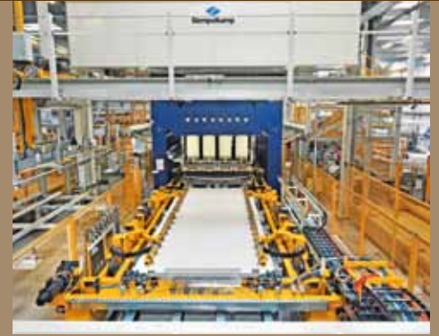
Ausfahrt der fertigen Platte aus der Presse
