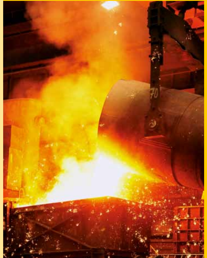
Abguss der 11-t-Gusskomponente
