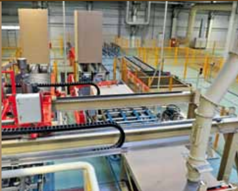
Zuführung der Rohplatten
